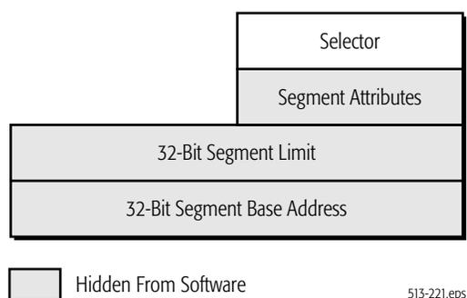
**Figure 4-4. Segment-Register Format**
