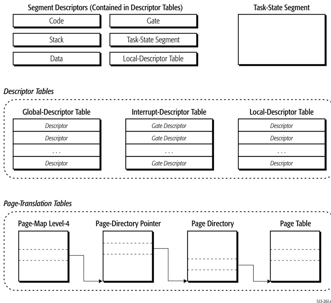
**Figure 1-8. System-Data Structures**
