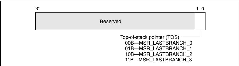
Figure 15-4. MSR\_LASTBRANCH\_TOS MSR Layout
