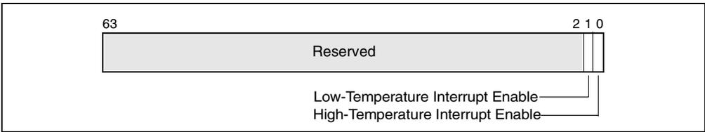
Figure 13-9. IA32\_THERM\_INTERRUPT MSR
