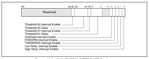
Figure 13-9. IA32\_THERM\_INTERRUPT Register
