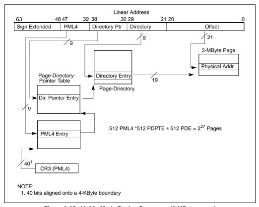
Figure 3-25. IA-32e Mode Paging Structures (2-MByte pages)
