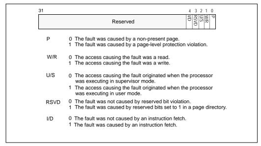
Figure 5-9. Page-Fault Error Code
