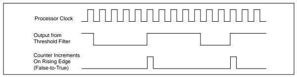
Figure 18-38. Effects of Edge Filtering
